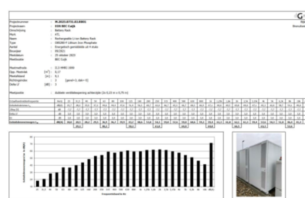
figuur 15: meetformulier dubbele ventilatieopening achterzijde Battery Rack
